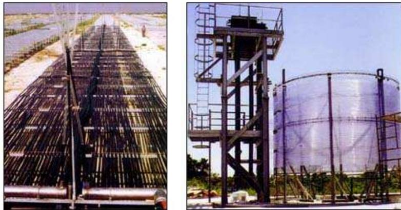
Figures 50a (à gauche) et 50b : La photo de gauche représente un photobioréacteur industriel linéaire (© Microalgae S.p.a. Italy) ; celle de droite montre un photobioréacteur circulaire (© Addavita Ltd. UK) [135].
