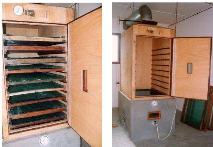
Figures 16a et 16b : Cabines de séchage (au Bénin) chauffées au gaz, permettant l'installation de neuf plateaux recouverts de spiruline essorée.
