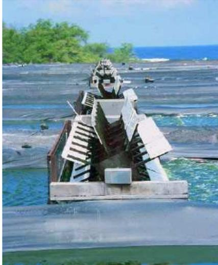
Figure 31 : Roues à aubes assurant l'agitation du milieu de culture des bassins.
