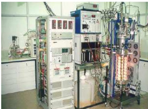
Figure 52 : Photobioréacteur (ESTEC, Noordwijk) fonctionnant en continu pour la culture de *Spirulina platensis*; on peut apercevoir les bidons d'alimentation en milieu frais et de récolte de la biomasse posés par terre.
