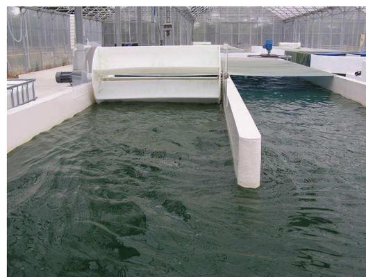
Figures 41a (à gauche) et 41b : Bassins "raceway" installés sous serre appartenant à la société Alpha Biotech. La photo de droite montre le même bassin vu sous un autre angle. On distingue nettement le séparateur médian et le système de roues à aubes. © Alphabiotech 2006
