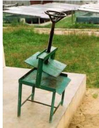
Figures 12 a (à gauche) et 12b : A gauche, c'est une presse type pressoir utilisée par J.P Jourdan. A droite, c'est une presse à vis, réalisée par les Ets AFAP (Pahou).
